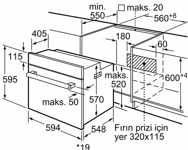
\* Metal ön cephe için 20 mm
