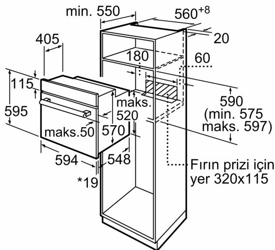
\* Metal ön cephe için 20 mm
